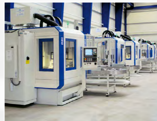
10 Maschinen DS 250 mit Ovalspeicher, paarweise aufgestellt, zur mannarmen Weich- und Hartbearbeitung von Zahnrädern für Nutzfahrzeuge
