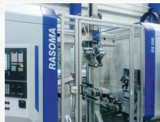
Vollautomatische Bearbeitung von 1. und 2. Spannung, Wenden des Teiles Radnabe im Greifer
