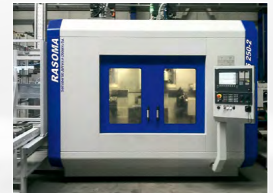
DZS 250-2 mit zwei Motorspindeln, zwei Kreuzschlitten und zwei 12-fach Sternrevolvern zur simultanen Bearbeitung von 1. und 2. Spannung
