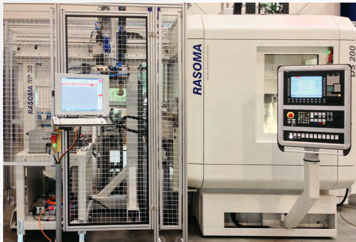
DS 200 mit Werkstückzu- und -abfuhrband, RASOMA-Portal RP 30 sowie externer Messstation (Farbgebung gemäß Lastenheft)
