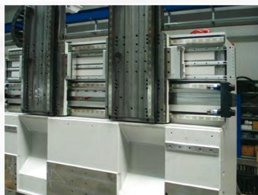
Grundaufbau der DZS-Maschinen, hier mit zwei Kreuzschlitten auf drei Linearführungen mit dazwischen liegendem Linearmotor
