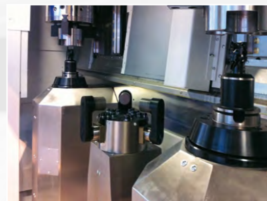
Simultanbearbeitung von Kupplungskörpern an zwei Bearbeitungsstationen einer DZS 315-2
